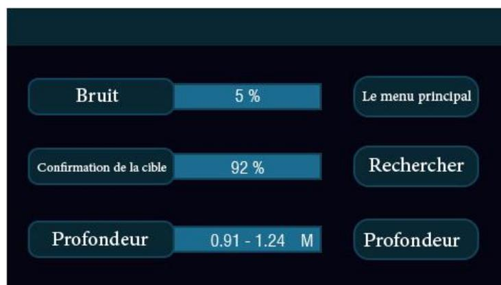
Les résultats et conditions suivants apparaîtront sur l'écran de l'appareil lors de la confirmation de la présence d'une cible :
