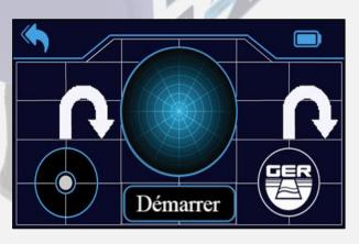
Dirigez l'appareil vers la cible tout en maintenant l'équilibre de l'appareil, appuyez sur le bouton de démarrage, attendez jusqu'à ce que vous entendiez un bip de l'appareil, puis marchez vers la cible jusqu'à ce que l'appareil tourne vers l'arrière avec l'appareil od une icône indiquant la rotation de l'appareil vers l'arrière.
