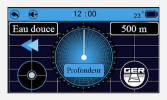
Après avoir confirmé l'emplacement de la cible, cliquez sur le bouton de profondeur pour déterminer la profondeur de la cible
