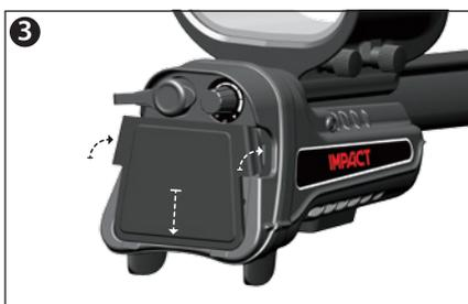
Remettez le couvercle en suivant la flèche (voir photo). Appuyez sur les languettes afin que le couvercle s'enclenche correctement.
