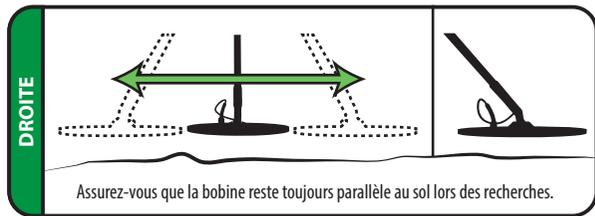
Tenez la bobine à une distance de 10 cm du sol. Assurez-vous que la bobine est parallèle au sol. Effectuez un balayage avec des mouvements lents de gauche à droite pour la détection précise de la cible.
