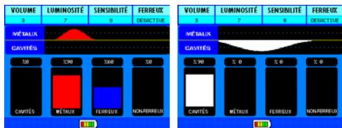
L'effet de la cible peut être contrôlé de façon consecutive sur le graphique (Oscilloscope) situé au-dessus de ces barres. Lorsque vous recevez un avertissement de l'appareil à tout moment, prendre l'appareil à distance à partir de ce moment-là et de le réinitialiser. Balayage suivant la bobine sur le même point encore. Ceci est fait pour confirmer la présence d'une cible.
