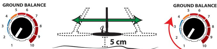
Apportez la balance au sol en position 1. Effectuez un balayage de gauche à droite à 5 cm au-dessus du sol. Si l'appareil reçoit toute interférence, pour le retirer, augmenter le niveau de balance au sol par petits incréments tout en balayant la bobine dans le même temps. Laissez le paramètre à l'endroit où le son s'éteint. Maintenant, le sol de votre sol est terminé.
