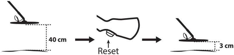
Soulever la bobine de 40 cm au-dessus du sol. Maintenant, en gardant la même distance au sol, appuyez sur le bouton de réinitialisation et d'abaisser la bobine à 3 cm. (Si vous ne parvenez pas à soulever la bobine de 40 cm au-dessus et commencer en appuyant sur le RESET, aucune opération à effectuer par la suite ne sera exacte.)
