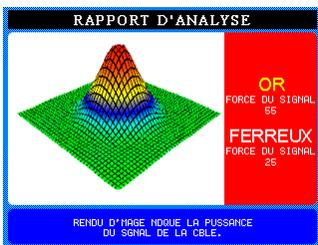
Pour obtenir l'analyse d'une cible détectée lors de la recherche, Eloignez le disque de la cible détectée et appuyez sur le bouton RESET.
