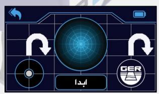
قم بتوجيه الجهاز نحو الهدف مع الحفاظ على توازن الجهاز راضغط على زر ابدأر انتظر حتى سماع صوت تنبيه يصدر من الجهازر ثم قم بالسير باتجاه الهدف حتى يقوم الجهاز بالدوران نحو الخلف مع ظهور ايقونة تدل على دوران الجهاز نحو الخلف،
